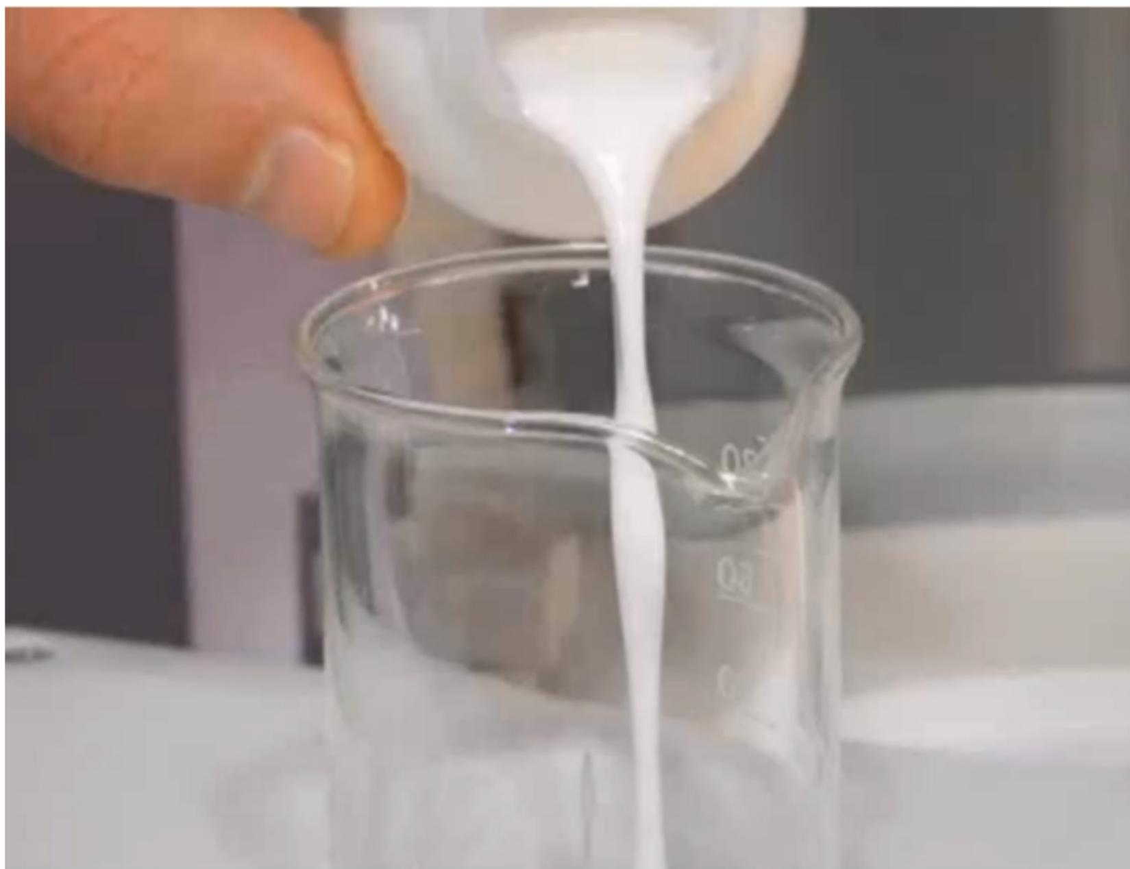
I FLUIDI ELETTRORREOLOGICI SONO MATERIALI CHE MODIFICANO LE PROPRIE CARATTERISTICHE REOLOGICHE (E.G. VISCOSITÀ) MEDIANTE L'APPLICAZIONE DI UN CAMPO ELETTRICO.
